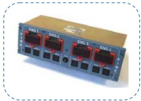
L'**ICP04** est équipement qui englobe les poignées coupe feu des 4 moteurs et permet ainsi de visualiser si un feu a pris dans les réacteurs et permet alors de déclencher les extincteurs (2 de chaque côté par moteurs).
