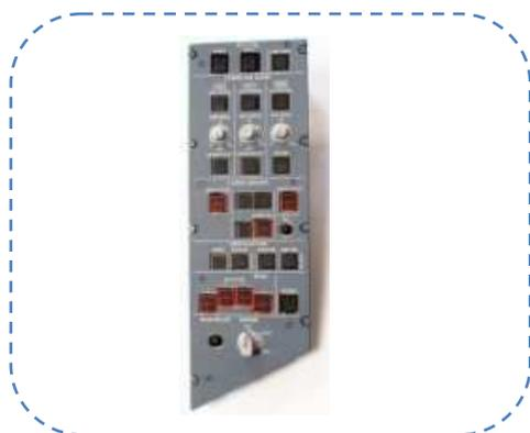
L'**ICPo9** permet de contrôler l'air conditionné et la détection de fumée dans les soutes, de gérer la ventilation et les essuis glace. Il permet également de contrôler l'état du vol en général.
