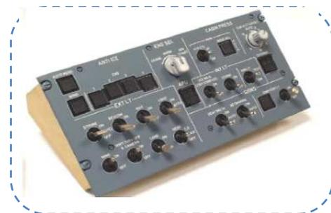
L'**ICP07** permet de contrôler le démarrage automatique des moteurs, les éclairages extérieurs (le flasher en bout d'aile, la lampe en haut de la dérive, la caméra en cas de demi tour de nuit, le phare pour atterrir) et intérieurs ( changement de la luminosité, les ceintures de sécurité), la vanne de sortie d'air.
