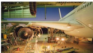
Figure 4 : Phase de démontage d'un moteur
