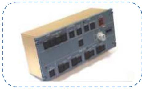
L'**ICP03** donne l'interface homme/machine avec les systèmes avions tels que l'interface moteur, l'oxygène, la cabine, le courant électrique, l'hydraulique, le freinage, le fuel, les eaux usées, l'humidificateur et la radio-communication.
