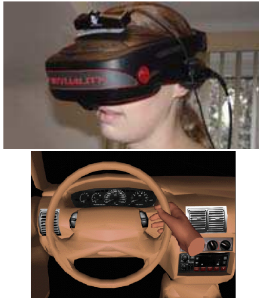
Figure 1.13. Mode immersif (a) Casque HMD (b) Représentation d'une partie du conducteur.
