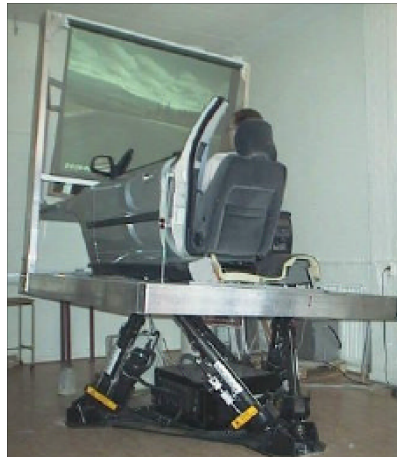
Figure 1.4. Simulateur à plateforme parallèle de l'université de Chalmers - Suède.
