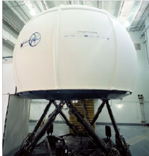
Figure 1.6. Simulateur à plateforme Gough-Stewart du VIRTTEX - USA.
