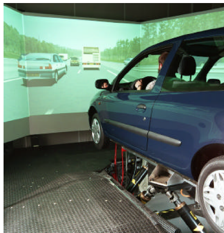
Figure 1.5. Simulateur dynamique de Renault - France.
