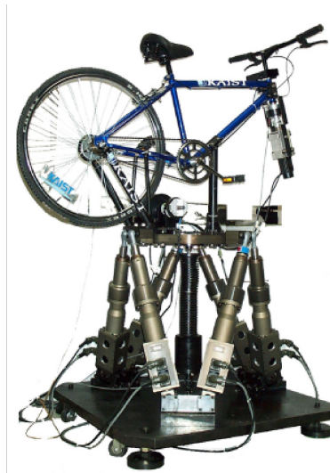
Figure 1.31. Simulateur du véhicule deux-roues non motorisé - Corée.
