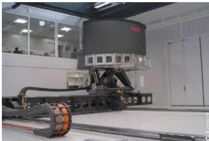
Figure 1.7. Architecture hybride du simulateur ULTIMATE de Renault - France.
